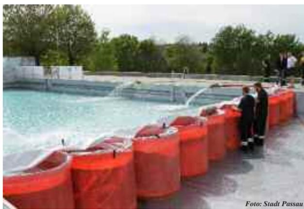
Das mobile Hochwasserschutzsystem wurde zu seiner Bewährungsprobe im Wellenbecken des Passauer Erlebnisbades „peb“ aufgebaut, wo es unter Wasser- und Wellendruck einer Hochwassersimulation standhalten musste. Jede der mit Wasser gefüllten und mit Folien verbundenen Plastiktonnen hat ein Gewicht von 1200 kg und hält stärkstem Druck stand. *Foto: Stadt Passau*
